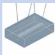
Химобработка (нанесение смазки под прокатку)
