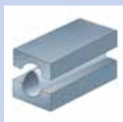
Окончательная формовка трубной заготовки
