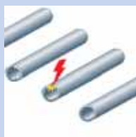
Отрезка концов труб на установке воздушно-плазменной резки, обработка концов, нанесение фаски
