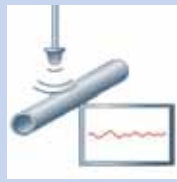
100-процентный автоматический ультразвуковой контроль шва
