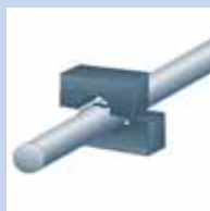
Раскрой штанг на технологические длины на пресс-ножницах холодной резки
