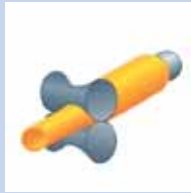
Прокатка прошитых гильз в трубы на стане пилигримовой прокатки
