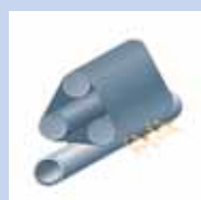
Шлифовка наружной поверхности (при необходимости)
