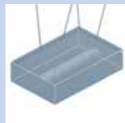
Химическая обработка (обезжиривание), травление (если трубы без механической обработки)
