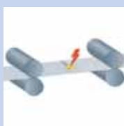
Обрезка и сварка концов рулонов между собой
