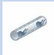
Снятие усиления внутренних швов по концам труб
