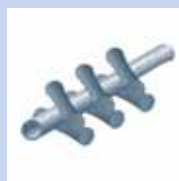
Правка кривизны трубы на косовальковой трубоправильной машине
