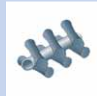
Правка труб на ковальковой правильной машине
