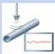
100-процентный автоматический ультразвуковой контроль шва
