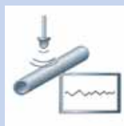
Контроль качества сварного шва труб электромагнитным дефектоскопом
