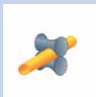
Прокатка труб на калибровочном стане
