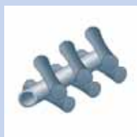
Правка кривизны труб на косовалковой правильной машине
