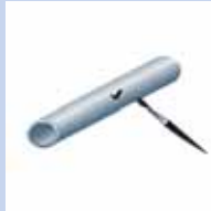
Предварительная маркировка труб краской
