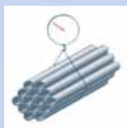
Пакетирование труб, взвешивание пакетов и прикрепление бирок
