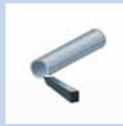
Изготовление фаски и кольца притупления на торце труб
