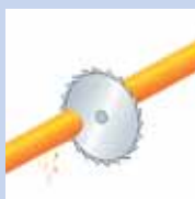
Порезка непрерывной трубы пилой на трубы заданной длины
