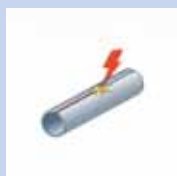
Сборка и сварка наружного шва трубной заготовки
