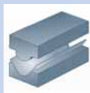
Окончательная формовка трубной заготовки
